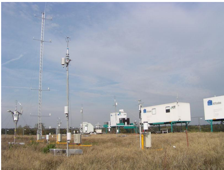
KITcube, ein mobiles High-Tech-Messfeld zur detaillierten Untersuchung von atmosphärischen Vorgängen. (Foto: KIT)
