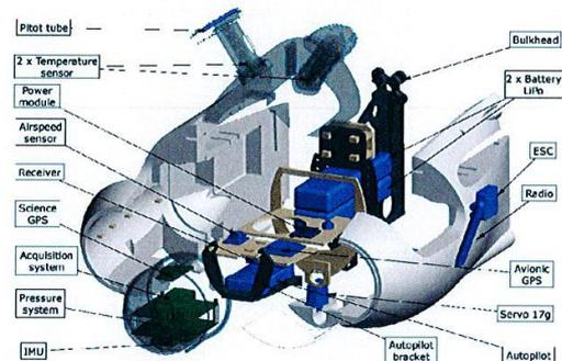
Figure 3 - Vue éclatée du fuselage (avionique en bleu et charge utile scientifique en vert)
