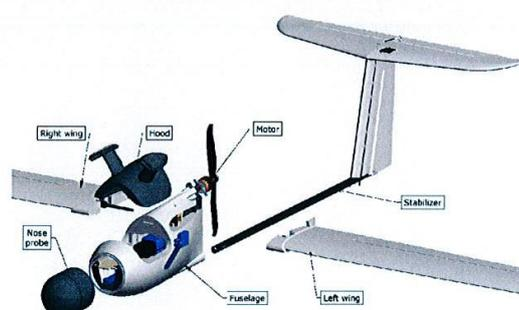
Figure 4 - Vue éclatée des sous-ensembles principaux
