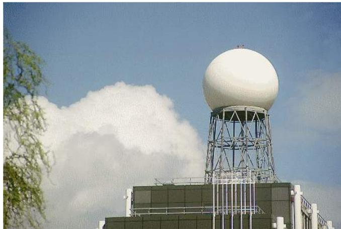
Abb. 2.11: C-Band Dopplerradar des Instituts für Meteorologie und Klimaforschung auf dem Gelände des KIT Campus Nord.
