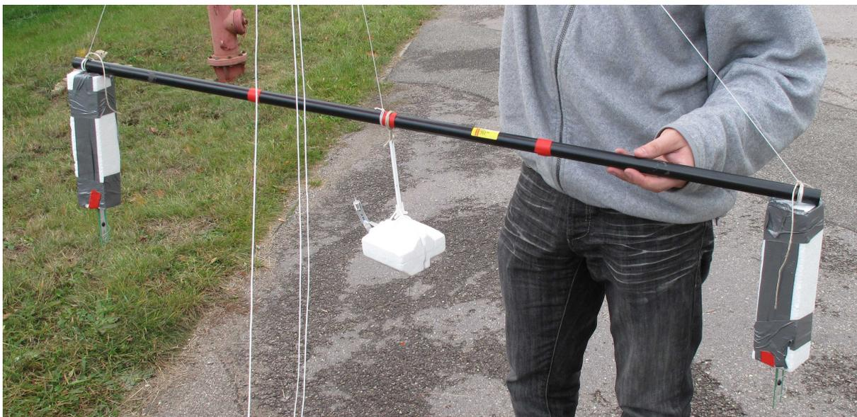
Abb. 3.9: Anbringung der GRAW-Sonden an einer Stange etwa 10 m unterhalb der Karlsruher Drop-Up-Sonde.
