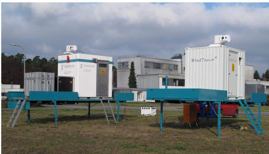
Das Lidar (Light Detection and Ranging)-Netzwerk des IMK besteht aus drei Doppler Lidar-Systemen: zwei leistungsstarken, nahezu baugleichen "WindTracer" Systemen (auf LKW Wechselbrücken) sowie einem "WindCube" (im Bild zwischen den "Windtracer" Systemen), der die operationsbedingte Messlücke bis ca. 350 m Entfernung der "WindTracer" abdeckt.
